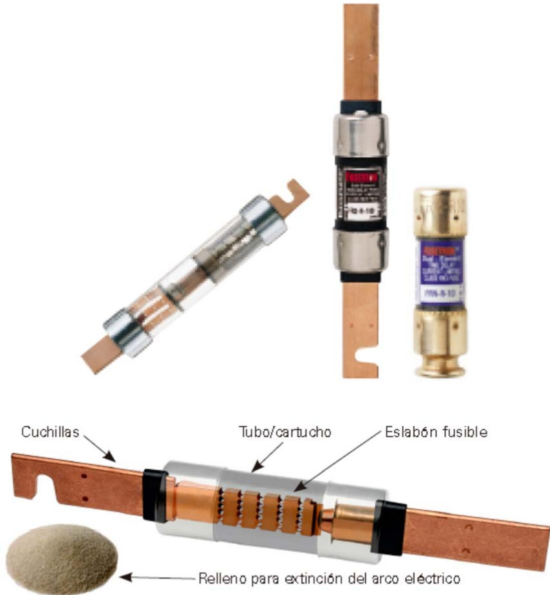
**Figura 2.** Fusible LPS-RK, Low-Peak, de doble elemento y retardo de tiempo, que muestra las cuatro características de construcción comunes.
