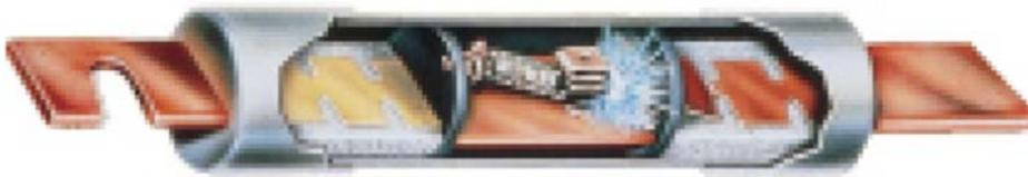
Se produce una apertura del elemento central, bajo una condición de sobrecarga sostenida en el tiempo.
